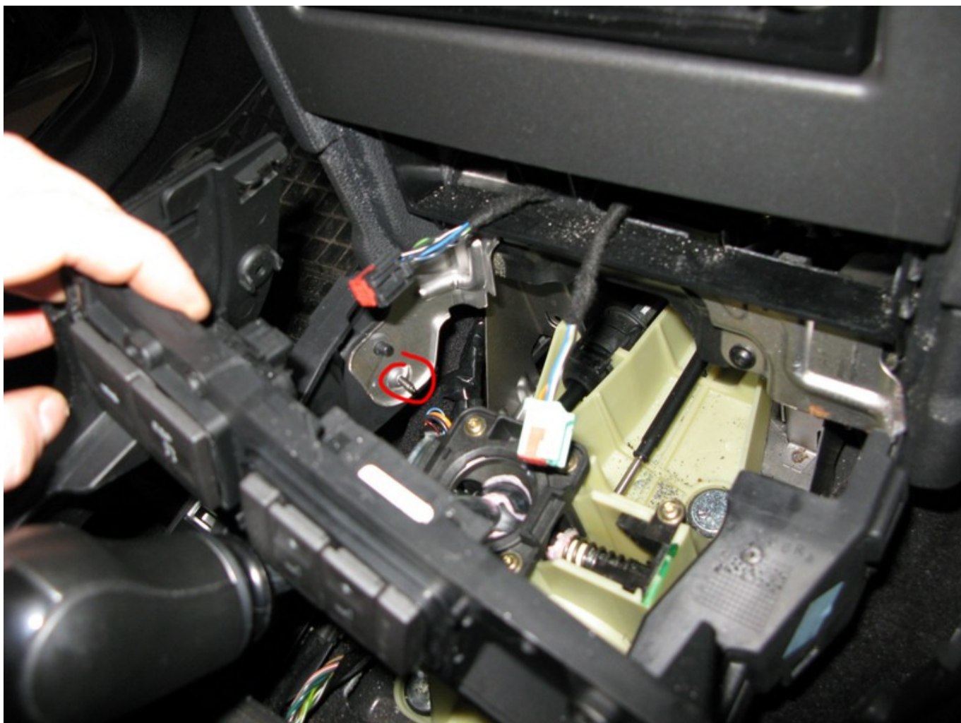
9) Demontujemy metalową "ramkę"/wspornik (klucz torx)
